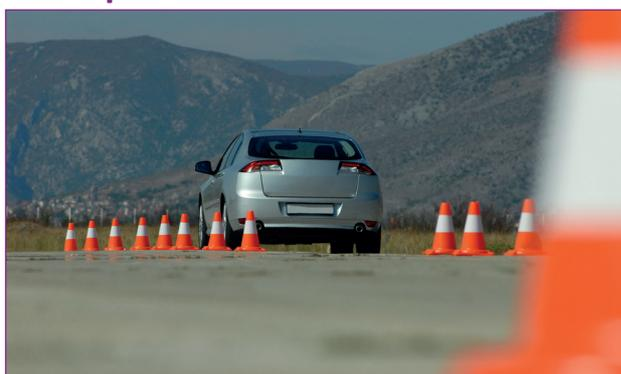
Nous mettons à disposition un véhicule 5 places type monospace équipé d'un appareil de mesure embarqué, permettant d'afficher tous les paramètres liés aux essais de freinage. Il est possible d'utiliser pour ce module le véhicule de l'entreprise cliente (nécessite une prise allume-cigare).
